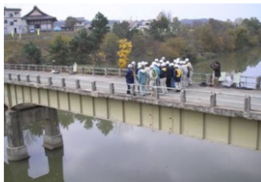
人力加振による振動試験
