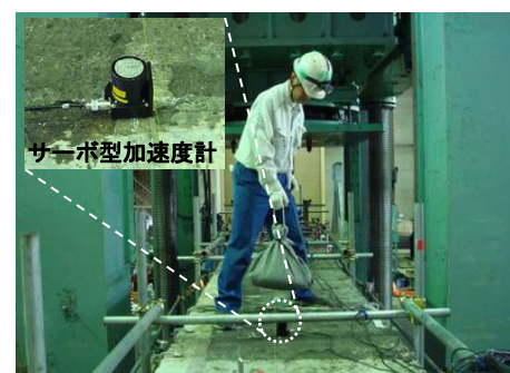
振動計測(砂袋による加振)
