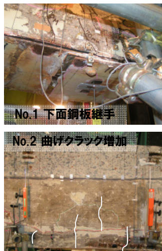
載荷試験後の破壊状況
