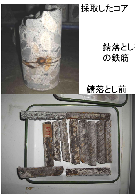
撤去橋脚の鉄筋の腐食程度
