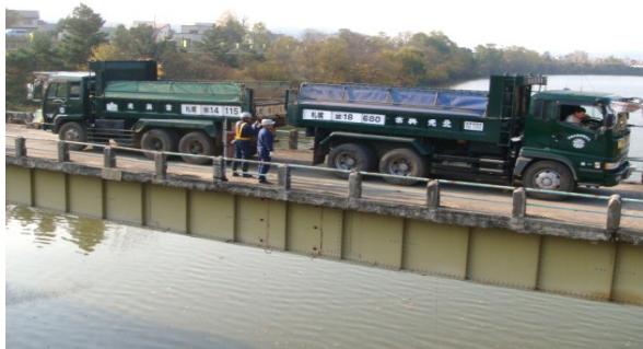
荷重車を用いた現地载荷試験
