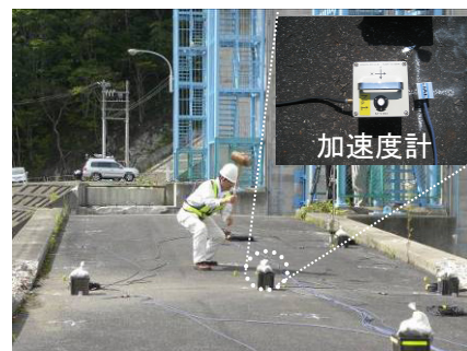
振動計測(かけや打撃による加振) (愛媛大学)
