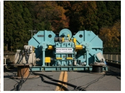
起振機による振動試験
