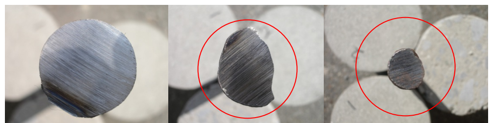
Φ25程度 比較的健全な鉄筋
