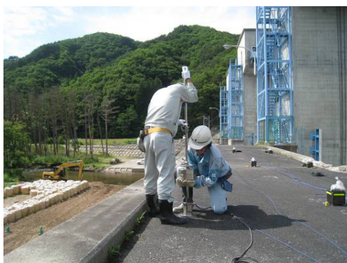
重錘落下法による加振
