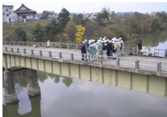
人力加振による振動試験
