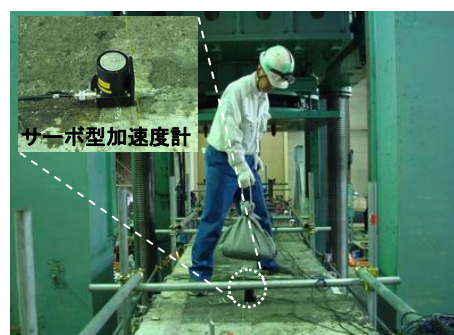
振動計測(砂袋による加振)
