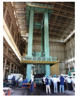
30MN試験機による公開試験の状況
