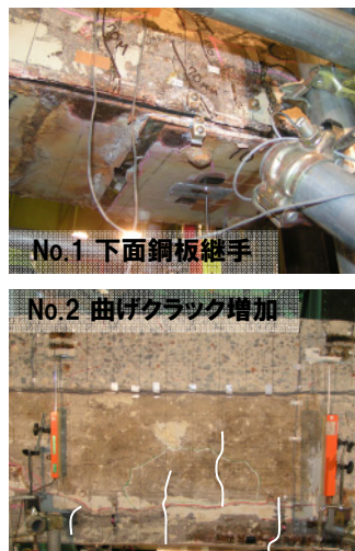
載荷試験後の破壊状況
