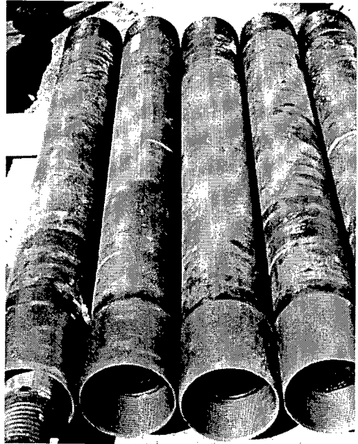
写真-解 3.4.2 HMP鋼管とカップリング
