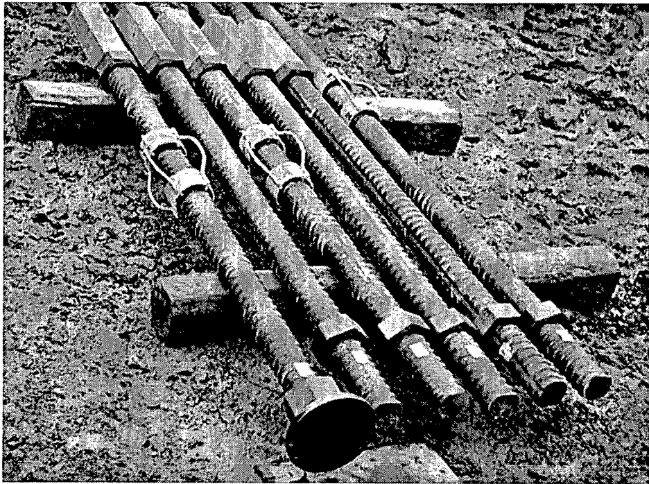
写真-解 2.6.1 セントライザーおよび沈下防止板の例
