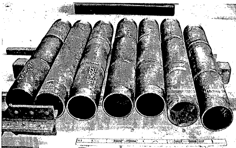
図-解 3.6.1 鋼管：鋼管径 216.3mm, L=1.5m
