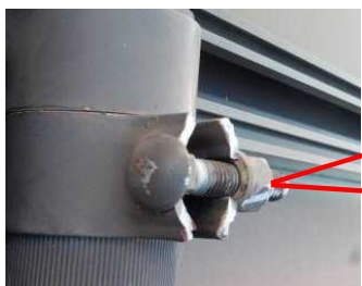
疲労の影響で破断した事例
