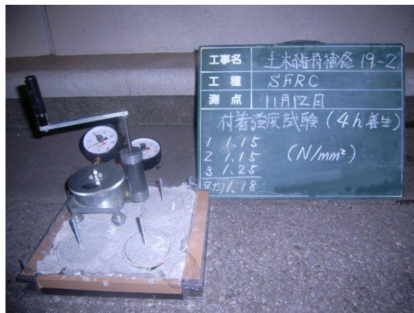
付図－Ⅱ－5 引張接着強度試験の状況
