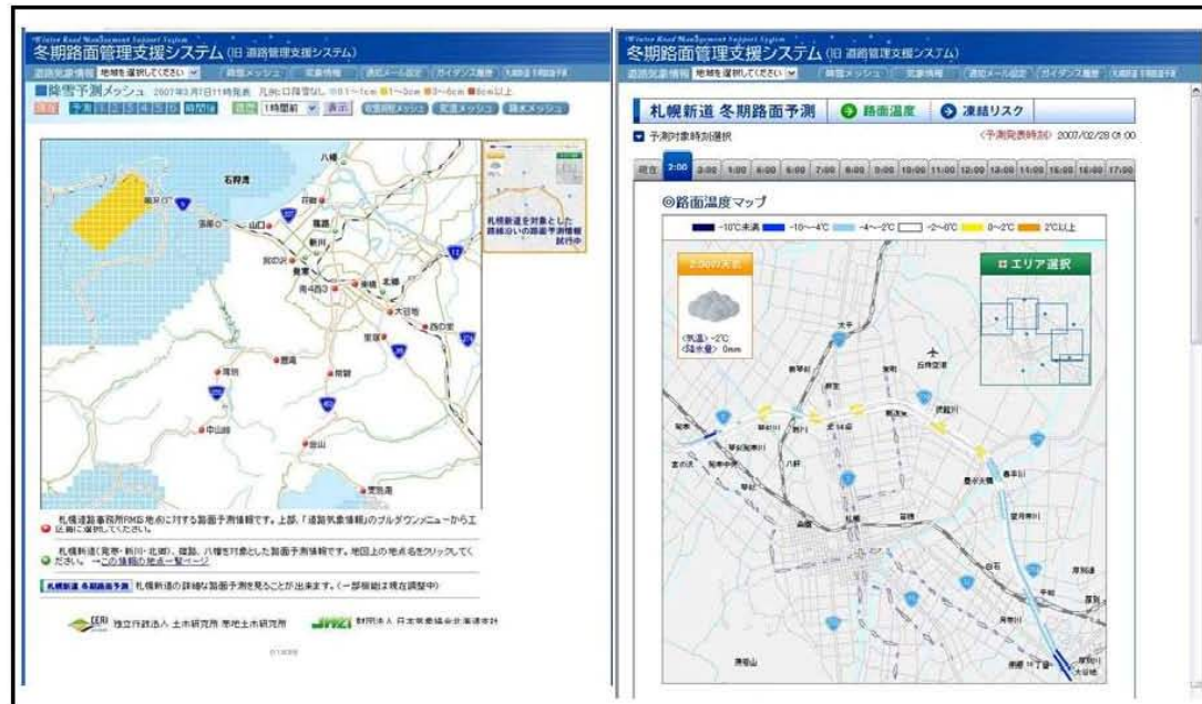
図-2 冬期路面管理支援システム（左：トップページ、右：路面温度予測画面）
