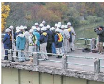
写真-1.5.22 人力での加振
