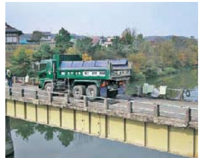
写真-1.5.21 大型トラックでの载荷
