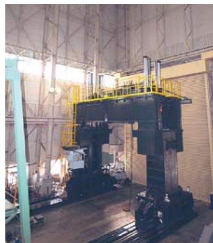
写真－7.1.2 構造物実験施設載荷設備整備（19年度）
