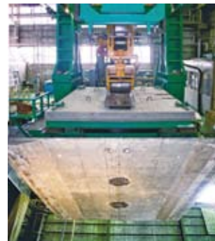
模擬損傷床版の輪荷重走行試験
