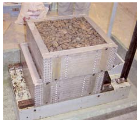
大型一面せん断試験実施状況
