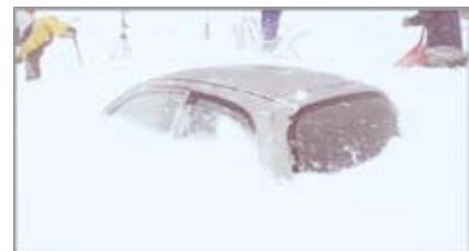
吹きだまりによる排気管閉塞状況
