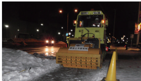
図-16.3 冬期歩道の雪氷路面処理技術
