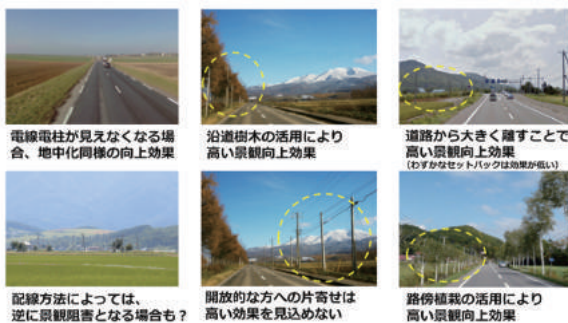
▲沿道環境に応じた電線電柱類の対策手法の分析
