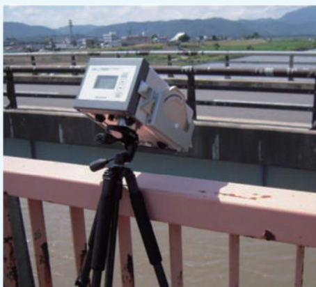
写真-1 非接触型流速計 計測状況
