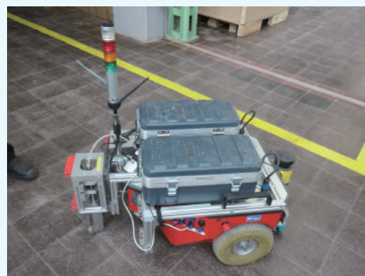
写真-4 BAM の開発した橋梁の非破壊検査装置
