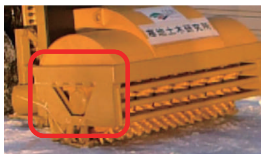
図-16.13 雪氷路面処理装置破碎部の改良
