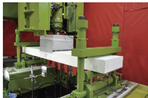
敷砂を設置した RC 梁衝撃実験
