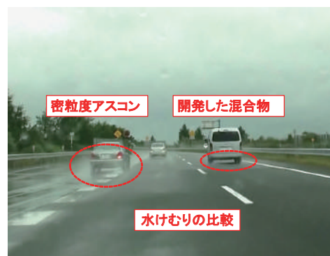
開発した混合物の雨天時の状況
