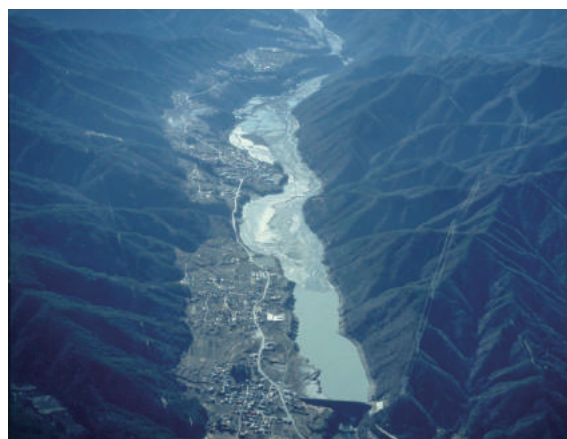
図-9.3 ダム湖における堆砂状況
