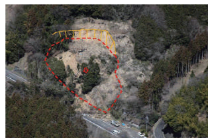
図 -3.12 地震による斜面地盤変状の例 (流れ盤の地質構造によるすべり)
