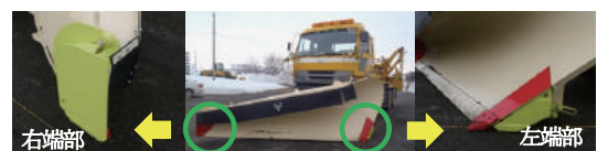
衝撃緩衝装置及び試験状況
