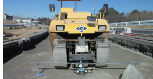
試験舗装区間での平板載荷試験
