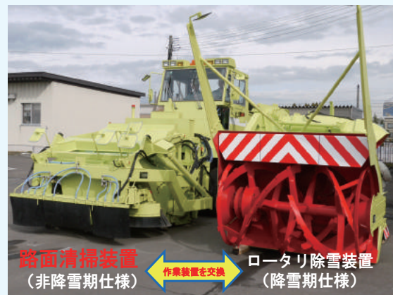
写真-2 開発した路面清掃装置
