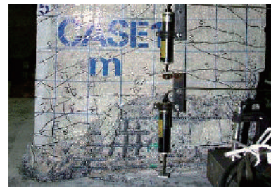
(a) 外面の損傷
