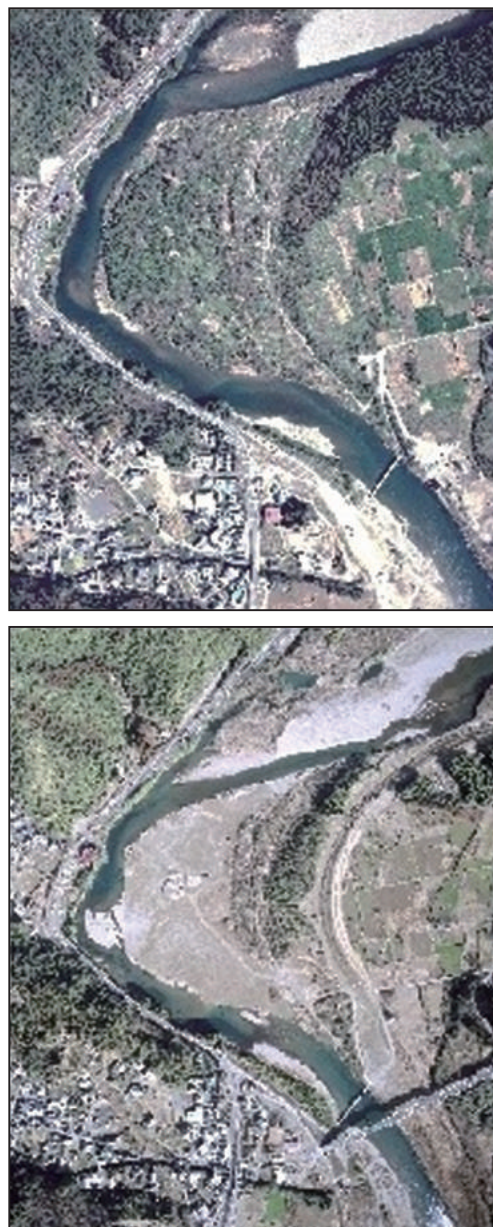
図-8.1 高水敷の切り下げと樹木管理 切り下げ前（上）、切り下げ後（下） 高水敷を切り下げた後の再樹林化をどう抑制するかは治水・環境・維持管理の観点から重要な課題となっている。
