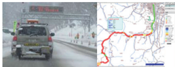
図-16.2 連続路面すべり抵抗値測定装置 (CFT) およびモニタリング結果の例
