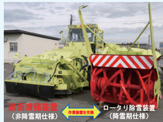
写真-2 開発した路面清掃装置
