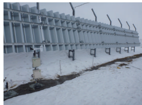
実物大新型柵を用いた現地試験
