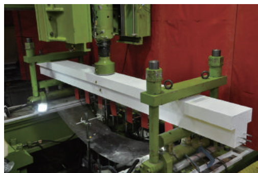
小型 PC 梁の衝撃実験状況
