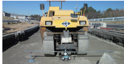
試験舗装区間での平板載荷試験
