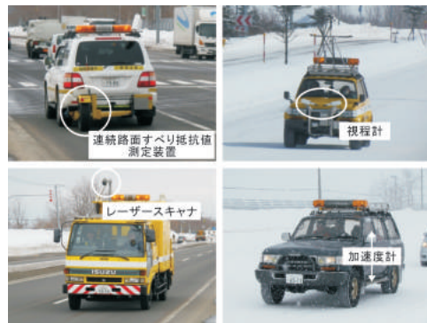
実道走行試験
