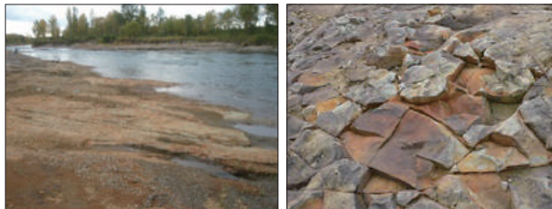
乾湿繰り返しにより表層が劣化した岩床
