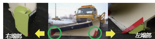
衝撃緩衝装置及び試験状況
