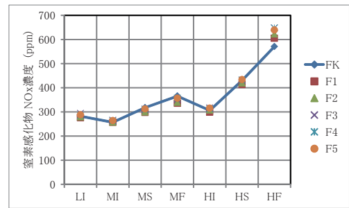
FK: 軽油 F1～F5: バイオ燃料 L1～HF: 運動モード 排出ガスの状況 (NO2)
