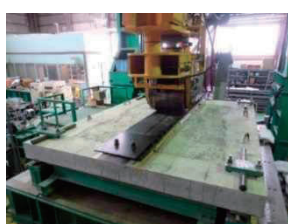
写真-1 床版の層状ひび割れ発生事例 写真-2 撤去床版の輪荷重走行試験
