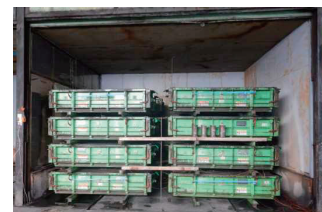
図-12 小型プレキャスト製品を対象とした蒸気養生実験
