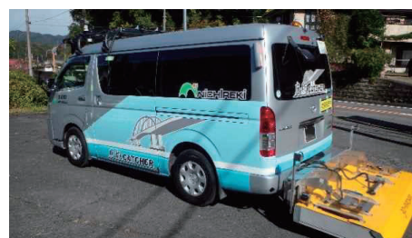
写真-3 車載式電磁波レーダ
