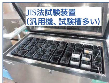
写真-1 耐凍害性の標準試験として普及している JIS A 1148A 法の凍結融解試験機
