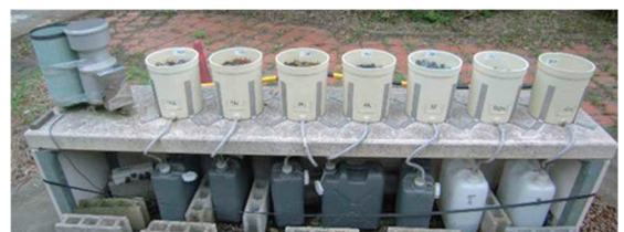
図-5 土研式雨水曝露試験の実施状況
