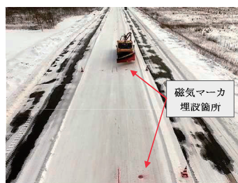
図-2 磁気マーカ埋設区間における除雪車の自動運行補助 除雪車の自動運行補助 （苫小牧寒地試験道路）
