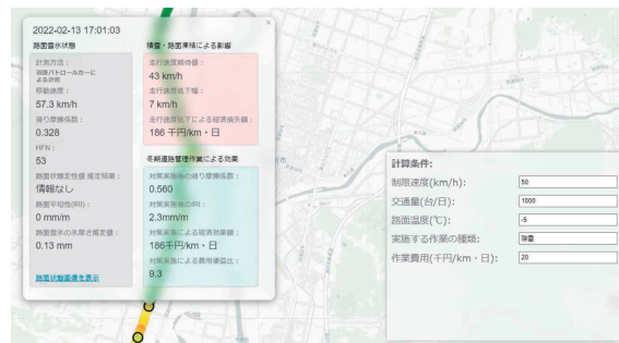
図-6 除雪・凍結防止剤散布作業等の費用対効果算定ソフトウェア
