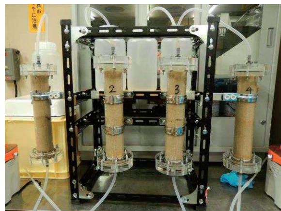
写真-3 上向流カラム通水試験の試験状況
