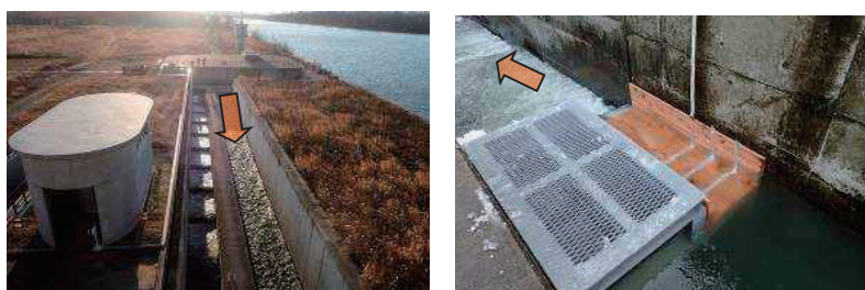
写真-1 十勝川千代田新水路の魚道に設置したシロサケ用魚カウンター
