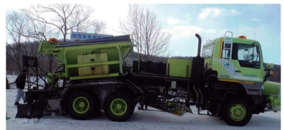
図-3 老朽化が著しい除雪機械 (メインフレームの折れ)
