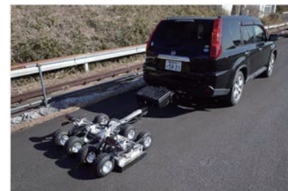
図-8 多チャンネル高速牽引型地中レーダ探査システム
