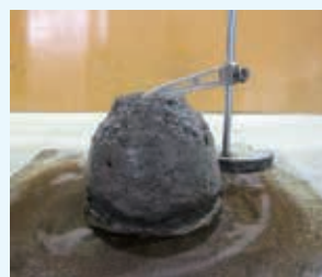
写真-2 スランプ試験後の試料適切な例（左：スランプ約8cm，右：スランプ約12cm）
