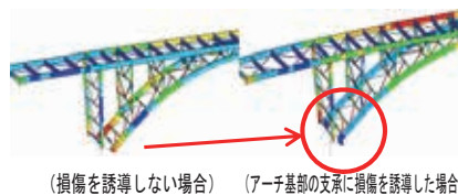
図-4 橋軸直角方向に载荷した場合のアーチリブに生じる応力状態
