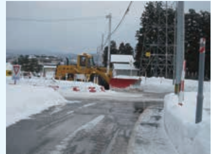
写真-1 除雪ドーザによる作業
