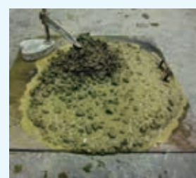
写真-3 材料分離した試料の例（左：セメント量の不足による材料分離，右：化学混和剤の過剰使用によるセメントペーストの分離）
