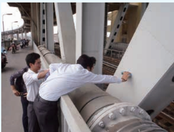
写真-1 ITSTと共同で実施した橋梁塗膜調査の状況（塗替え塗装後、早期に塗膜の光沢が失われている実態が明らかになった）
