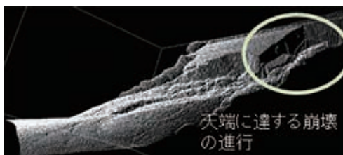
図-3 浸透模型実験で確認された崩壊の進行
