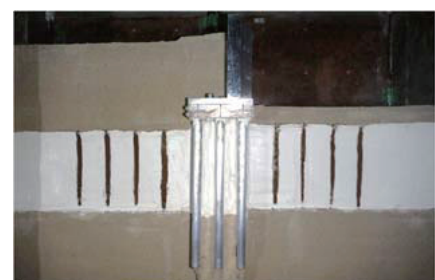
模型実験における橋台、 地盤の変形状況
