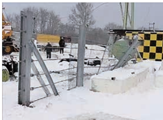
図-8 落石防護柵の重錘衝突実験状況
