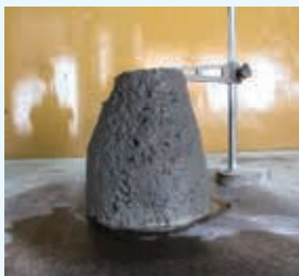
写真-2 スランプ試験後の試料適切な例（左：スランプ約8cm，右：スランプ約12cm）
