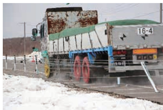
図-8 低張力（5kN）での性能確認試験
