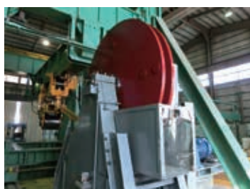
輪荷重載荷試験機改修
