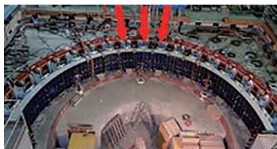
図-4 実物大の覆工載荷試験実施状況
