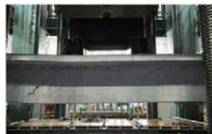
図-9 模擬損傷を有するPC箱桁供試体の載荷試験の状況
