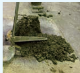
写真-3 材料分離した試料の例（左：セメント量の不足による材料分離，右：化学混和剤の過剰使用によるセメントペーストの分離）
