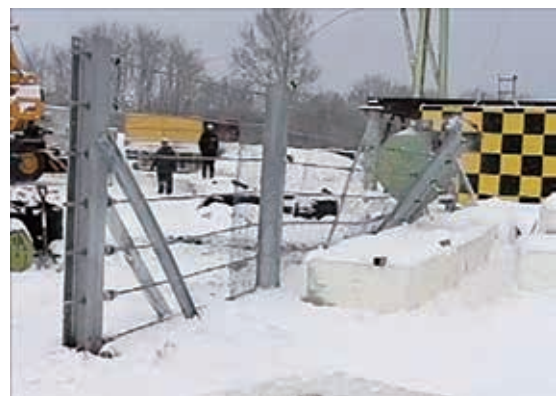
図-8 落石防護柵の重錘衝突実験状況
