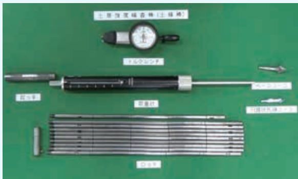
写真-1 土層強度検査棒の構成
