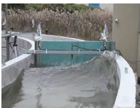
図-4 河川津波遡上実験による構造物への影響把握
