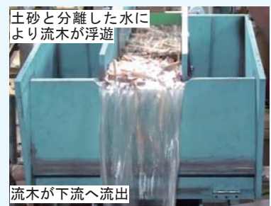
写真-2 水路実験の状況（流木が土砂と分離した後、流下している状況）
