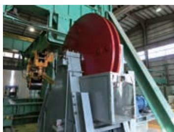
輪荷重載荷試験機改修
