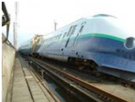
中越地震による 新幹線脱線
