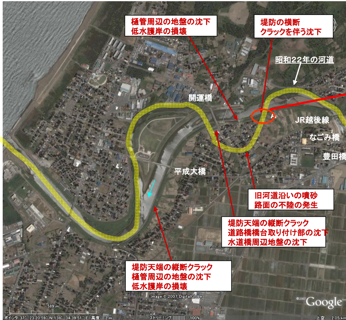
堤防の沈下(地点A) = 約1.2m
