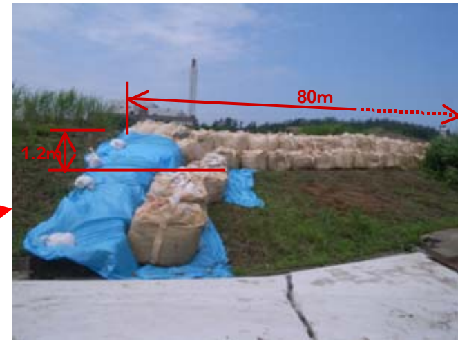
堤防の沈下(地点A) = 約1.2m
