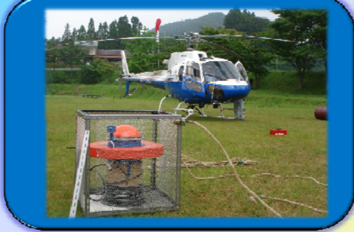
使用されたヘリコプターと投下型水位観測パイ
