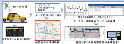
路面すべり抵抗モニタリングシステム概略図
