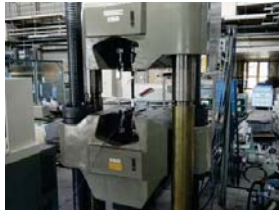
引張り試験の様子
