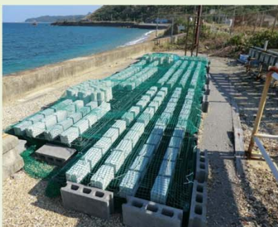
コンクリートの暴露試験の実施
