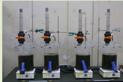
下水汚泥と刈草破砕物の 混合メタン発酵実験
