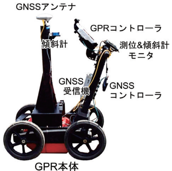
図-12 VRS-GNSS測位機能付きGPR試作機
