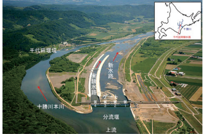
図-1 千代田新水路の施設配置
