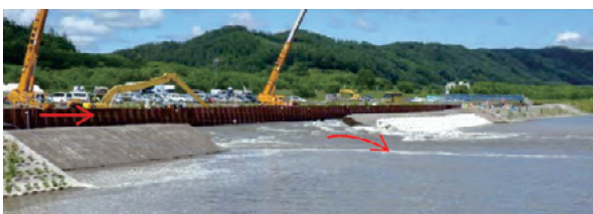
図-21 破堤幅が約30mで抑制 (根固めブロックありの場合)
