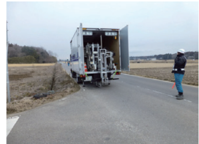
写真-13 FWD測定状況
