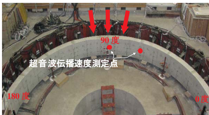
実大規模の覆工コンクリート荷重試験 (外径9.7m、覆工厚さ30cm)
