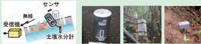
転倒検知センサーのしくみ 検知信号を発信するセンサー(3種) ○NETIS番号: KT-130093-A (感太郎)
