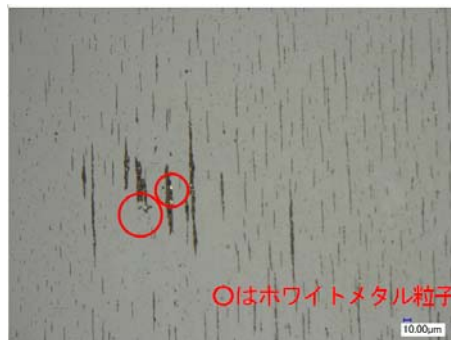
N排水機場 原動機フェログラフィ結果
