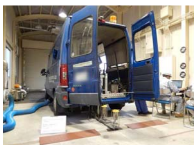
FWD検定実施状況
