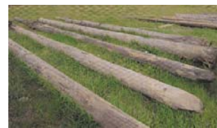
軟弱地盤に立地する堰の改修工事で，擁壁周辺及び前面に打設されていた松杭を引き抜いたところ，擁壁が川側へ変位。
