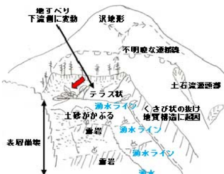
崩壊斜面スケッチ (7月8日時点)
