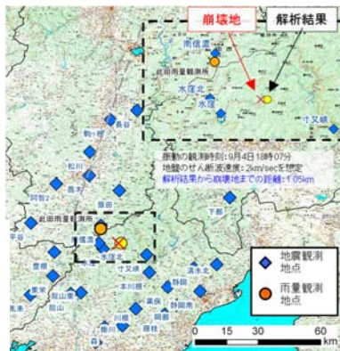
地震計を活用した大規模崩壊等の発生場所・時刻の推定※(静岡県浜松市水窪地区で発生した崩壊)
