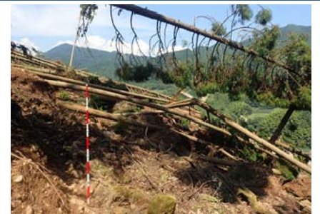
崩壊斜面のテラス状緩斜面部における段差地形 (2017年7月13日撮影)
