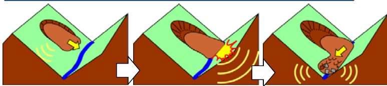
崩壊土砂の運動プロセスと地盤振動発生概念図
