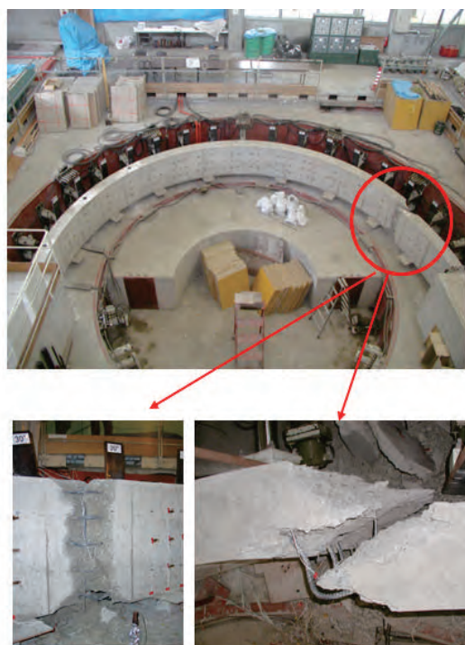
図-4 覆工載荷実験において覆工供試体の分離が抑制された事例
