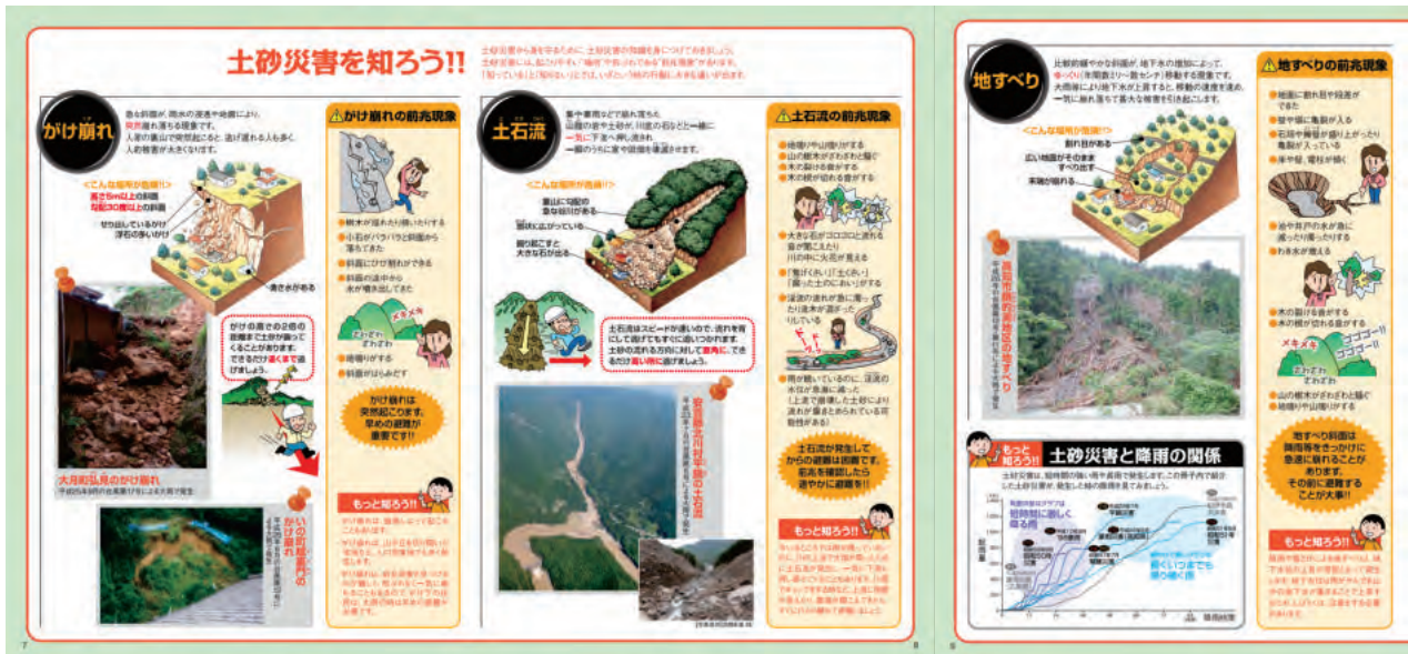
図ー1 土砂災害（急傾斜地の崩壊、土石流及び地すべり）の紹介事例 3)
