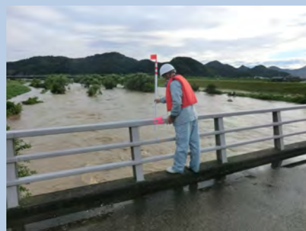
洪水時の流量観測（高水流観）
