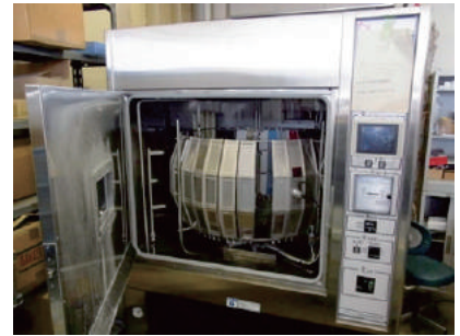
図-4 促進劣化試験機の例
