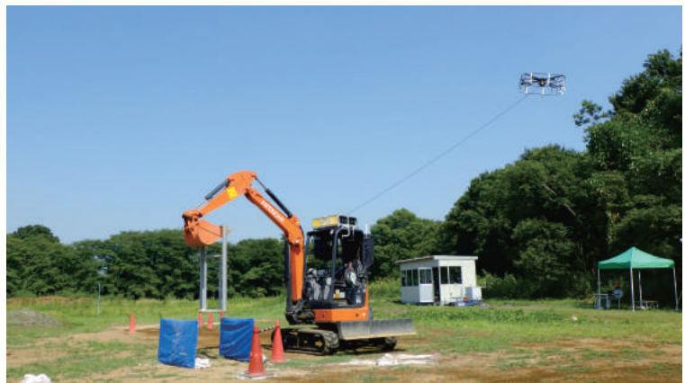
図-4 UAVによる機体・周辺把握の実験の様子
