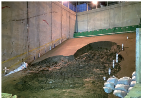
写真-2 大型模型実験による浸透滑りの再現
