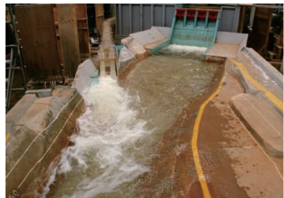
図-7 鹿野川ダム改造水理模型実験
