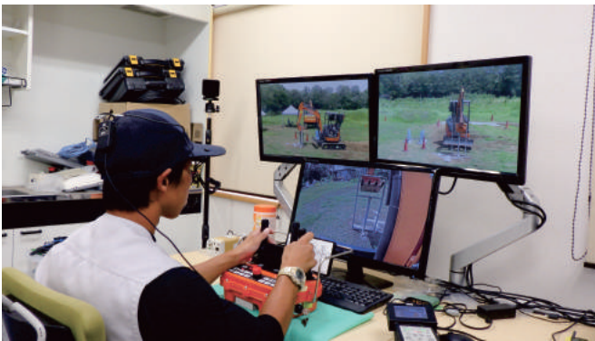
図ー1 油圧ショベルの遠隔操作の様子
