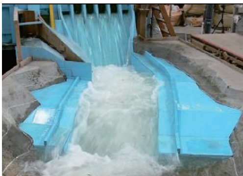
図-5 長安ロダム改造水理模型実験
