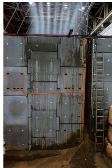
写真-4 異常降雨作用下での補強土壁の実大模型実験
