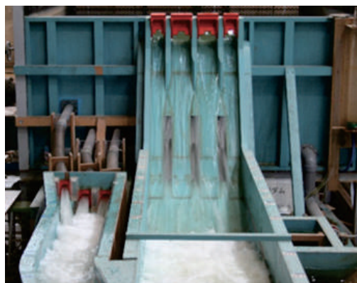
図-3 鶴田ダム再開発水理模型実験
