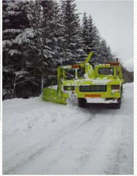
▲マックレーによる 堆雪の“かき出し”作業
