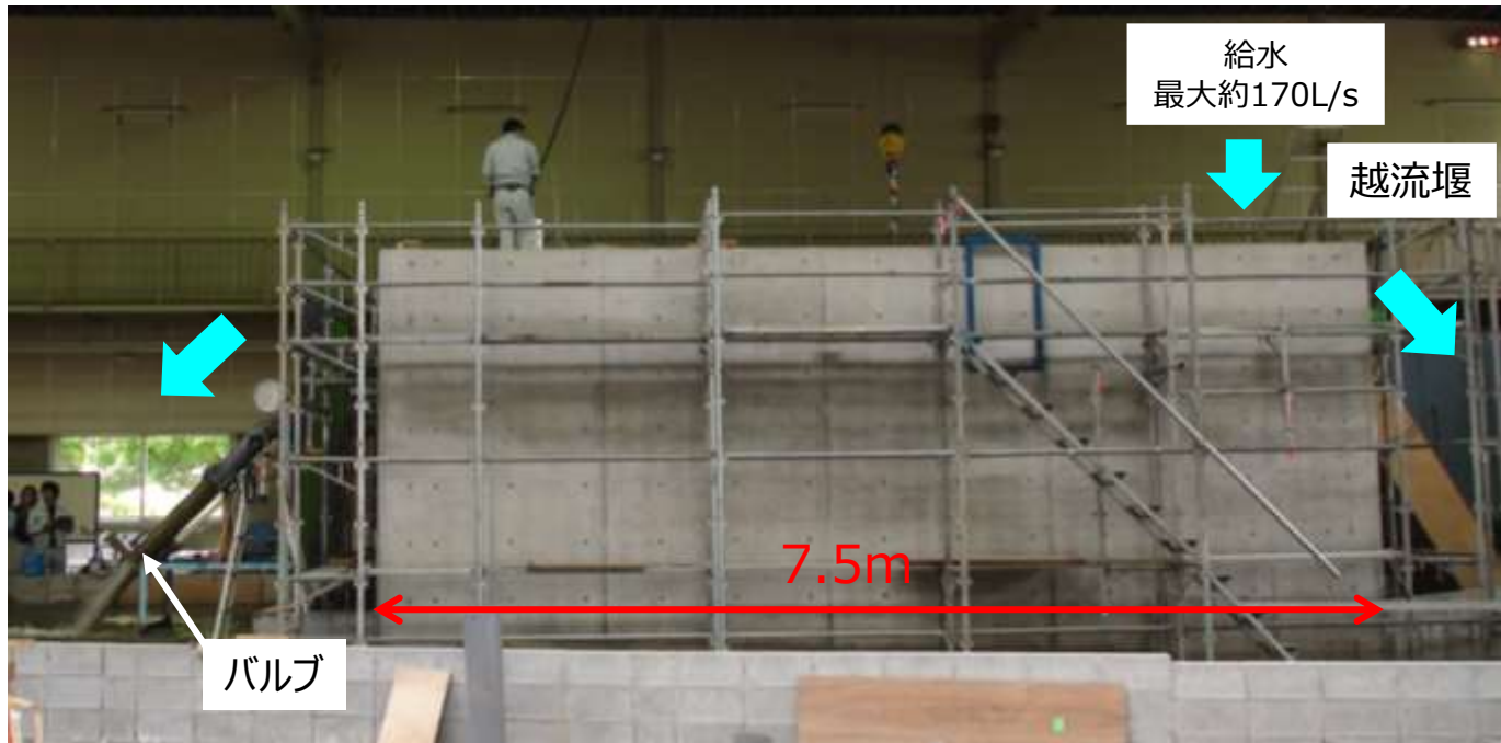
③水槽の水位を維持するための大量の水を要することから循環式で給水を行い、バルブを開けて排砂を行う。
