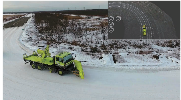
写真-5 ガイダンス性能検証実験状況
