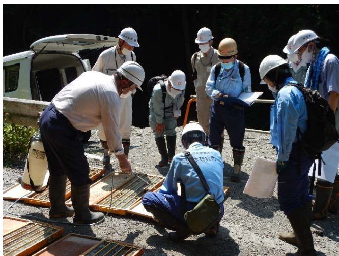
ボーリングコアの確認
