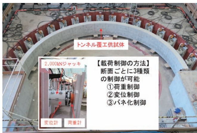
写真一1 覆工載荷実験装置
