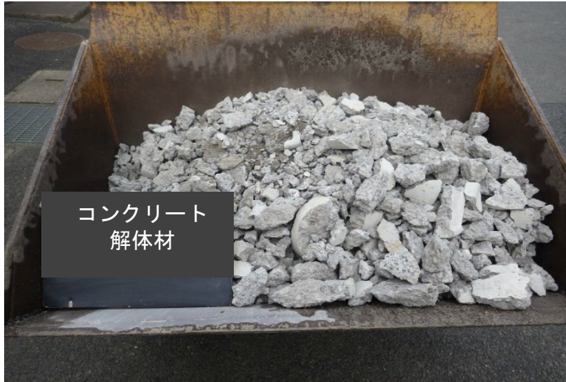
コンクリート塊 (解体材)
