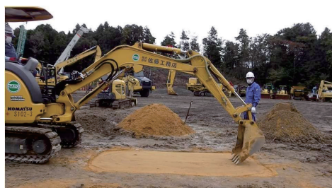
油圧センサを用いた反力測定
