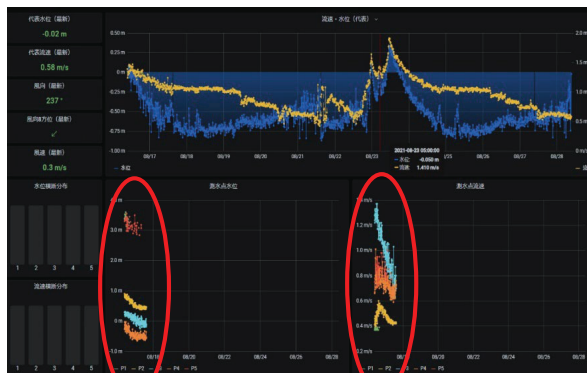
設定した水位を超えると測線毎の流速と水位を計測
