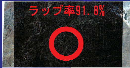
ラップ率91.8% 斜面からの距離: 50m 撮影水平移動距離: 6m
