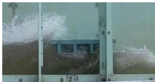
写真-1 橋梁模型の水路実験（左：水路の状況、右：実験時の写真）
