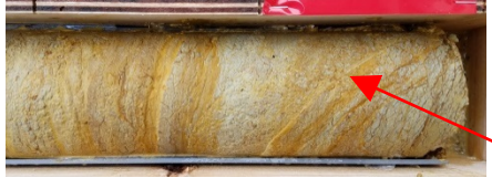
粘土フィルム挟在割れ目
