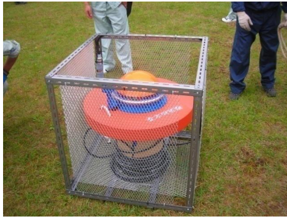
水位計の外観
