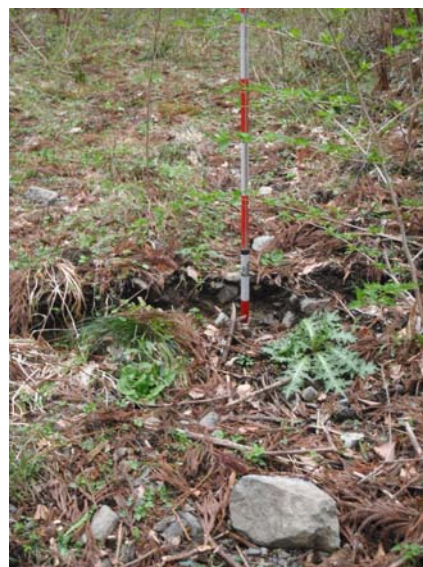
左写真の拡大。 走向はN55W、垂直変位量は15cm程度。
