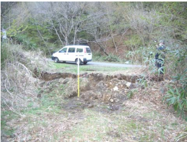
東を望む。断層の走向N5W、垂直変位量西落ち105cm。断層は写真右手で清道川を横断する。
