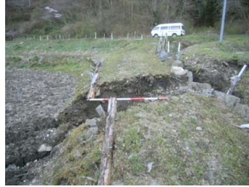
左写真中央付近、東を望む。左ずれ40cm。
