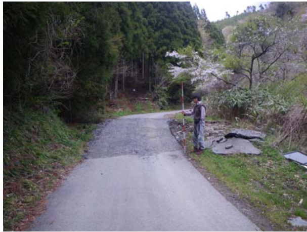
東を望む。断層の走向N35W、垂直変位量西落ち70cm。
