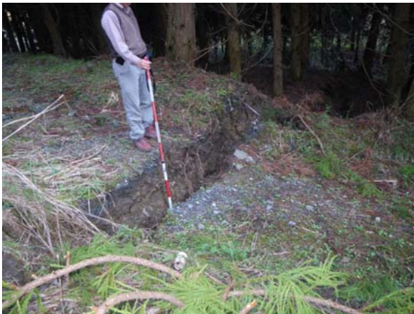
南を望む。走向N35W、垂直変位量西落ち40cm。
