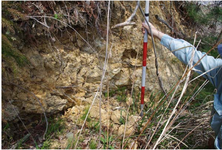
北を望む。走向N75E、垂直変位量最大で80cm。
