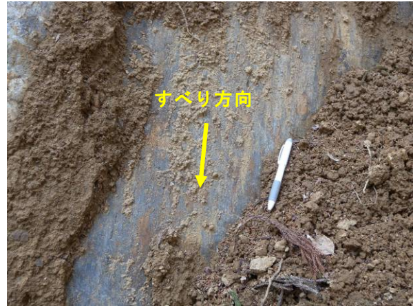
(d) 滑落崖で観察されたすべり面
